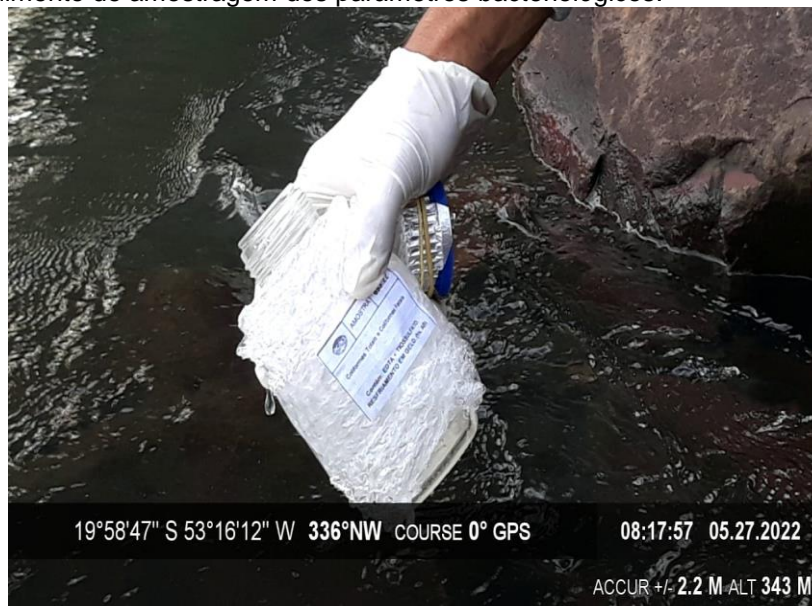
Figura 4 - Procedimento de amostragem dos parâmetros bacteriológicos.
