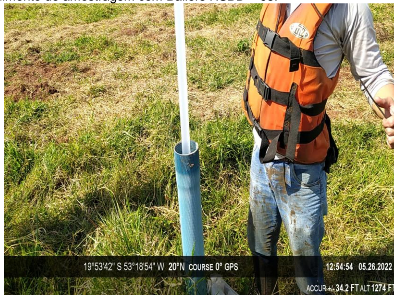
Figura 4 - Procedimento de amostragem com Bailers HSBD – 95.
