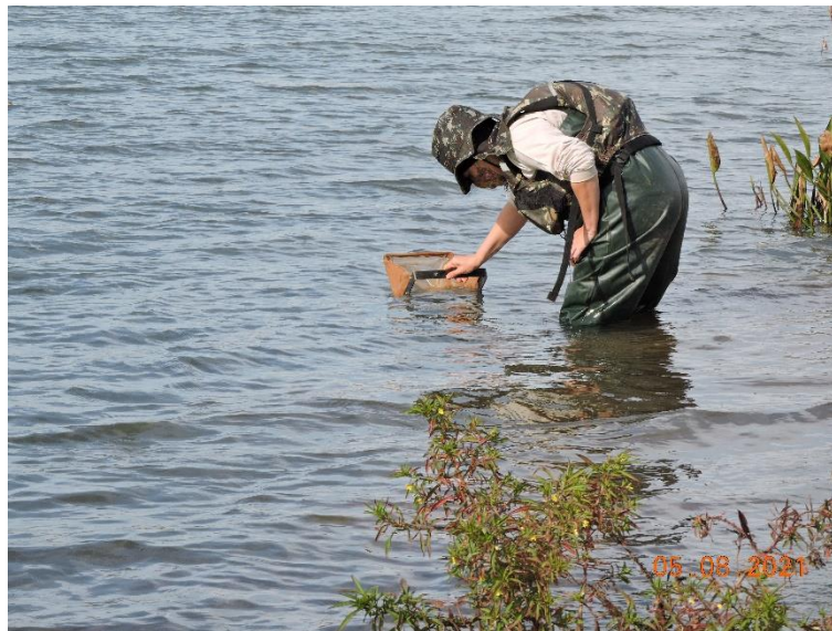
Figura 8. Amostrador do tipo surber sendo posicionado em habitat marginal do trecho de transição fluvial-limnética do reservatório da PCH Verde 4 em agosto de 2021, para coleta de amostra de zoobentos.
